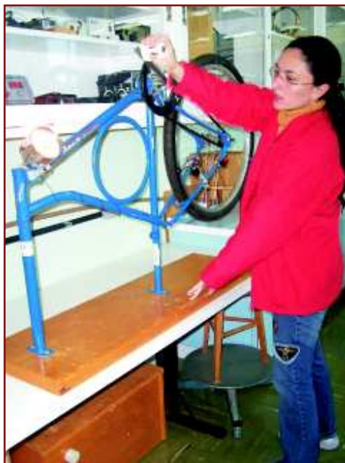
Figura 51: O esforço para movimentar o dínamo gera a energia que acende o farol
