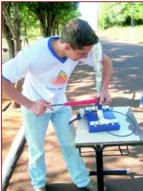
Figura 53: Foguete sendo pressurizado com uma bomba de bicicleta
