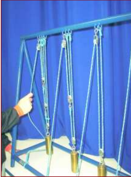
Figura 63: Fazer menos força requer mais deslocamento da corda
