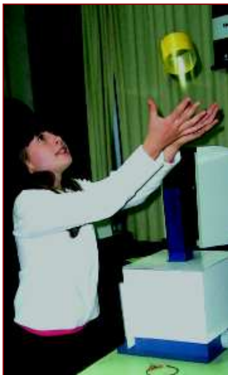
Figura 3: A interação entre dois campos magnéticos projeta o anel para o alto
