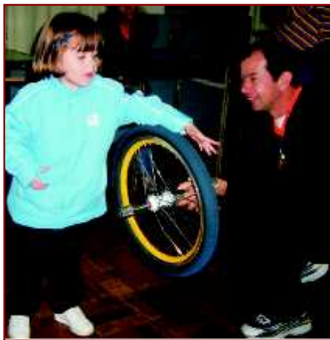
Figura 14: Roda de bicicleta para simular o efeito produzido por um giroscópio
