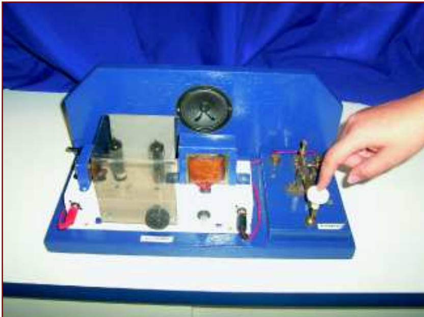
Figura 90: Dispositivo para mostrar o princípio de funcionamento do telégrafo
