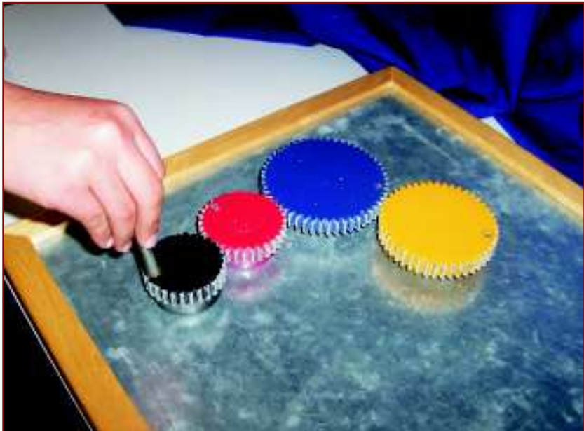
Figura 85: Transmissão do movimento através do contato de engrenagens
