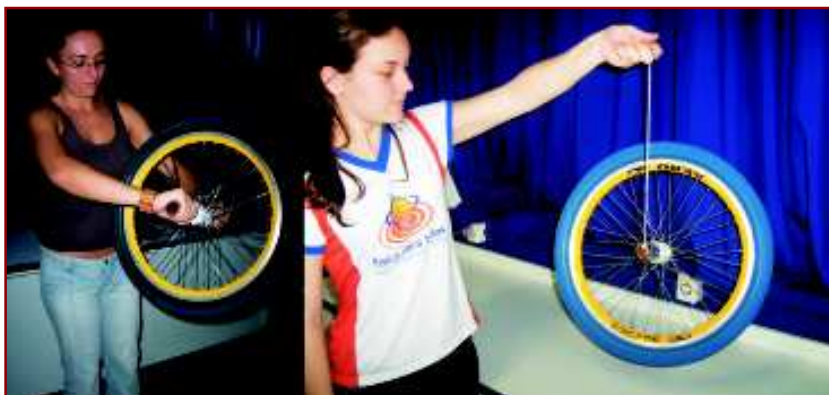
Figura 15: O movimento de rotação garante estabilidade ao giroscópio
