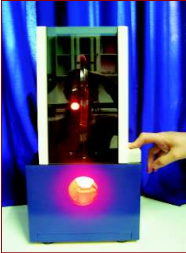
Figura 25: Luz aprisionada no interior de um tubo transparente de acrílico se propaga da base até a extremidade superior por sucessivas reflexões
