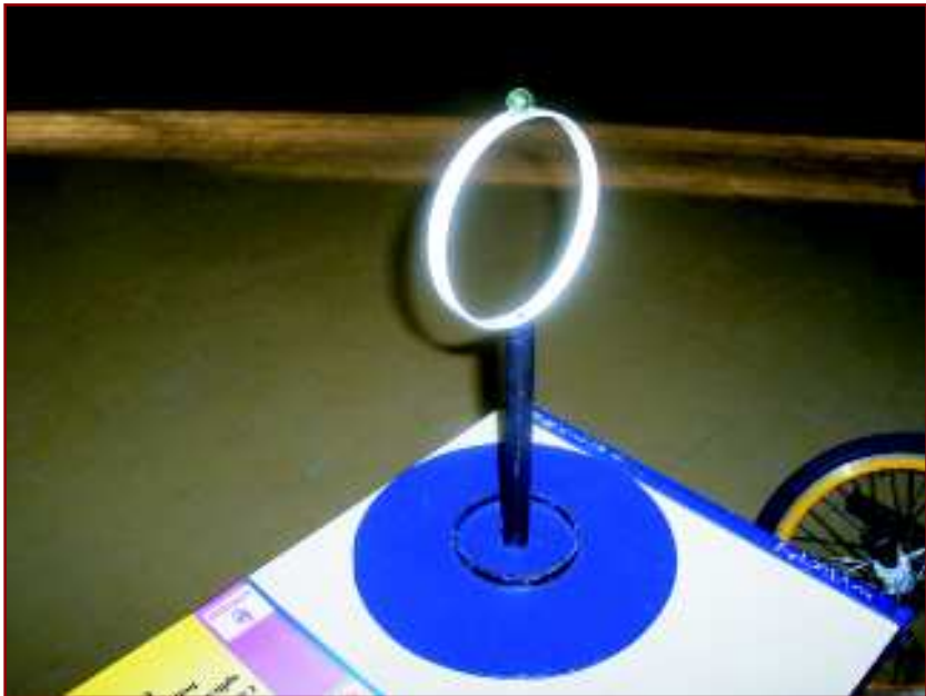
Figura 72: Bolinha de gude apoiada na argola e, esta, no tubo de PVC
