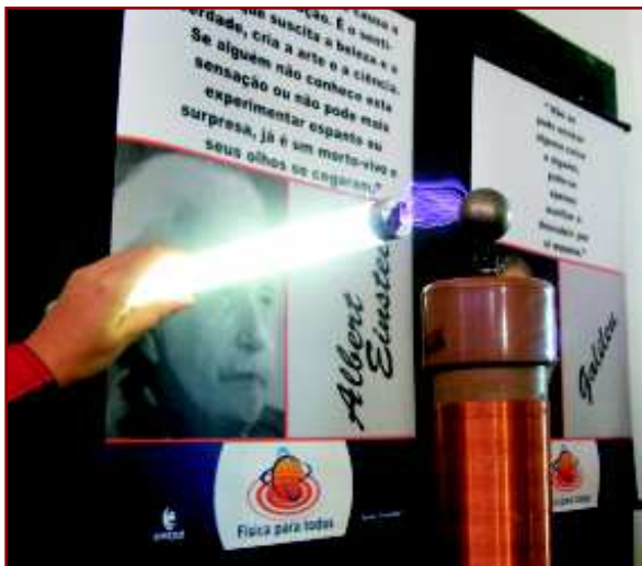
Figura 8: As descargas elétricas ativam a lâmpada fluorescente, fazendo-a emitir luz
