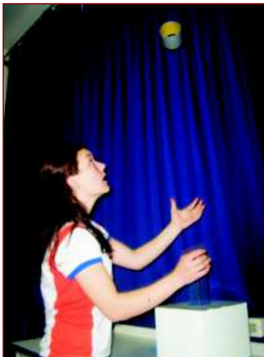
Figura 4: Anel resfriado em nitrogênio líquido sofre maior repulsão
