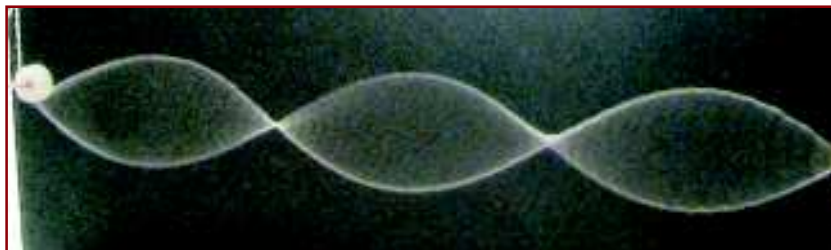
Figura 93: Onda estacionária com três ventres e 1,5 comprimentos de onda
