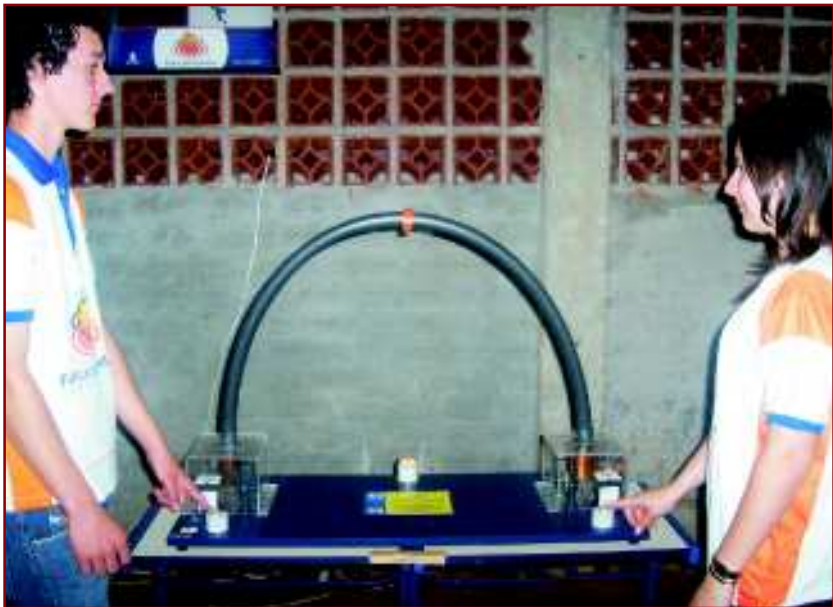
Figura 5: Confinado pelo arco, o anel de alumínio salta de uma bobina para a outra
