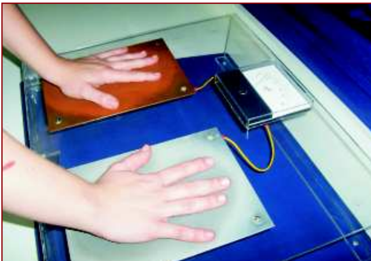
Figura 50: O suor ácido das mãos funciona como solução eletrolítica
