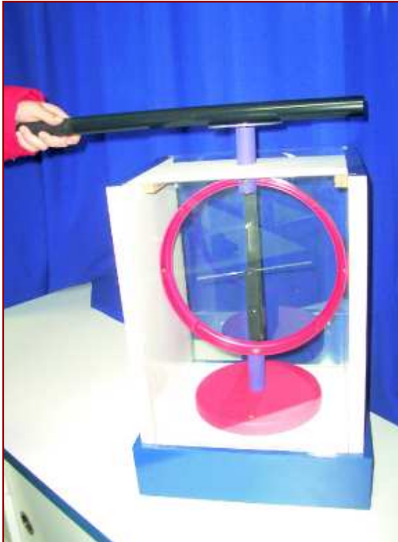
Figura 60: Eletrização do eletroscópio por contato com um bastão de PVC
