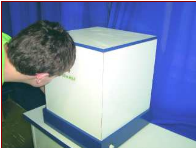
Figura 29: Caixa de espelhos paralelos
