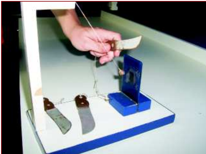
Figura 23: Faca de ferro interrompe a interação entre o ímã e a esfera de bombril
