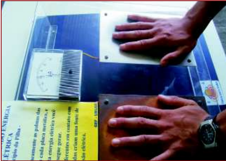
Figura 49: As mãos da pessoa, apoiadas nas placas metálicas, dão origem a uma corrente elétrica que é registrada no microamperímetro
