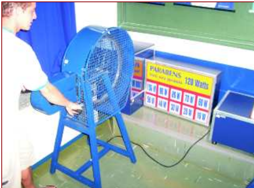
Figura 52: O painel ilustra, em Watts, a potência produzida no dínamo
