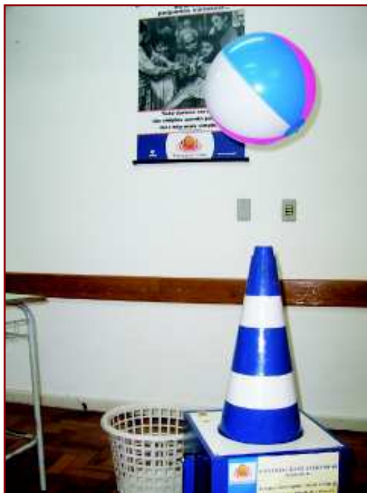
Figura 56: A bola aprisionada pela correnteza de ar
